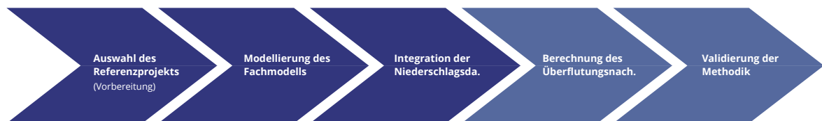
Abb. 4: Methodisches Vorgehen zur BIM-gestützten Integration des modellbasierten Überflutungsnachweises. (Eigene Darstellung)
