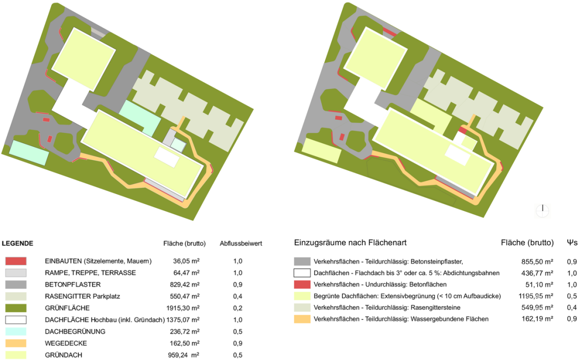
Abb. 31: Vorgegebene Einteilung der Flächen aus dem Referenzprojekt auf der linken Seite, unverändert. (STORCH.LANDSCHAFTSARCHITEKTUR 2024); Einzugsräume nach Flächenarten mit Flächenaufteilung und Abflussbeiwerten gemäß DIN 1986-100 (Tabelle 9) auf der rechten Seite. (Eigene Darstellung)
